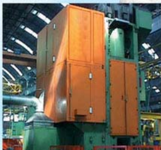
BONIFICA DI UNA PRESSA A FRIZIONE
